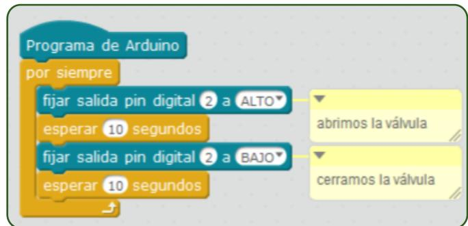
Al asignar el estado «ALTO» a la salida del relé («pin digital 2») estamos indicando que se envíe una corriente de 5V para el relé que permita el paso de corriente a la electroválvula para que se abra.
